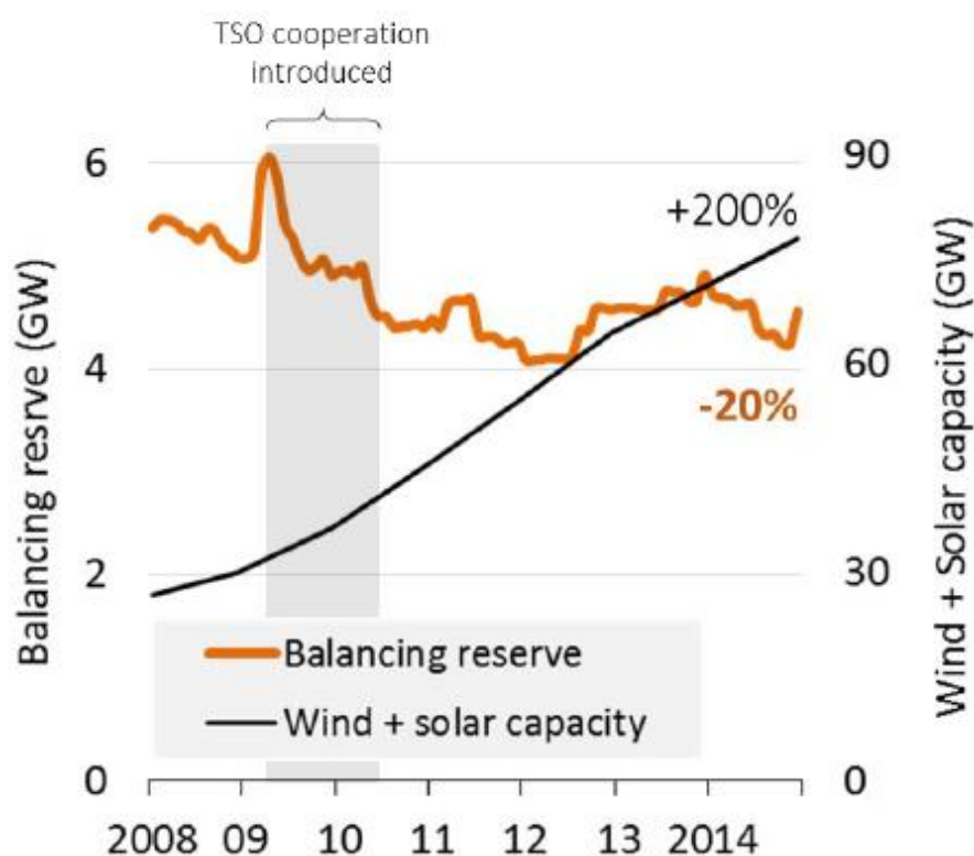
80. ÁBRA: A NÉMETORSZÁGI IDŐJÁRÁSFÜGGŐ KAPACITÁS ÉS A LEKÖTÖTT RENDSZERSZINTŰ TARTALÉK KÖZÖTTI KAPCSOLAT
